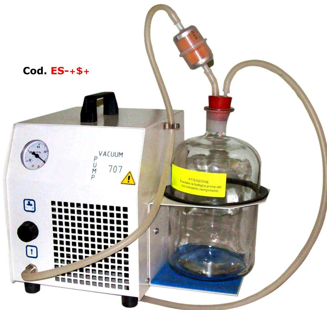
La pompe à vide ES-707 est utilisé dans les laboratoires de biochimie, pharmacie et de microbiologie pour la vidange et dans l'analyse colorimétrique et spectrométrique. Il fournit une filtration plus facile par des entonnoirs Buckner et fournit des solutions stérilisées à travers une membrane à filtre spécial.
